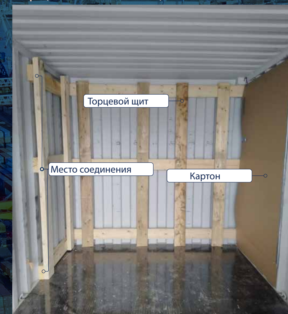
Торцевая стена с щитом
