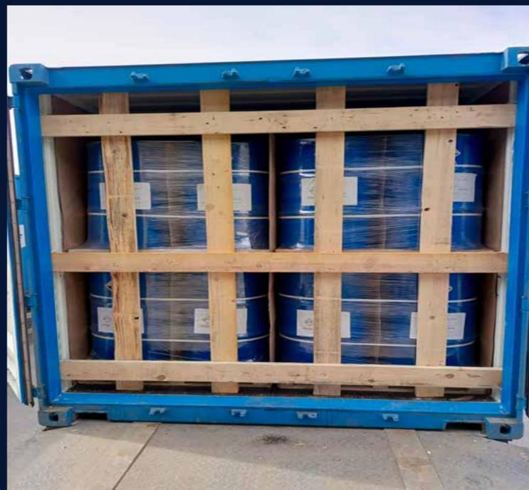
Дверной проем оборудуется щитом, состоящими из 3-х горизонтальных досок размером 50 мм x 150 мм, длина доски определяется от одной гофры до другой (концы опилить для плотного входа в гофры) и 4-х вертикальных досок толщиной доски от 25 до 50 мм и шириной 150 мм, длина определяется по всей высоте погрузки. Доски соединены между собой гвоздями диаметром 3-4 мм и длиной гвоздя от 70 до 100 мм, по два гвоздя в соединение. ЗАПРЕЩАЕТСЯ ПРИМЕНЕНИЕ ГВОЗДЕЙ С ВЫХОДОМ ОСТРОГО КРАЯ В СТОРОНУ ГРУЗА.
