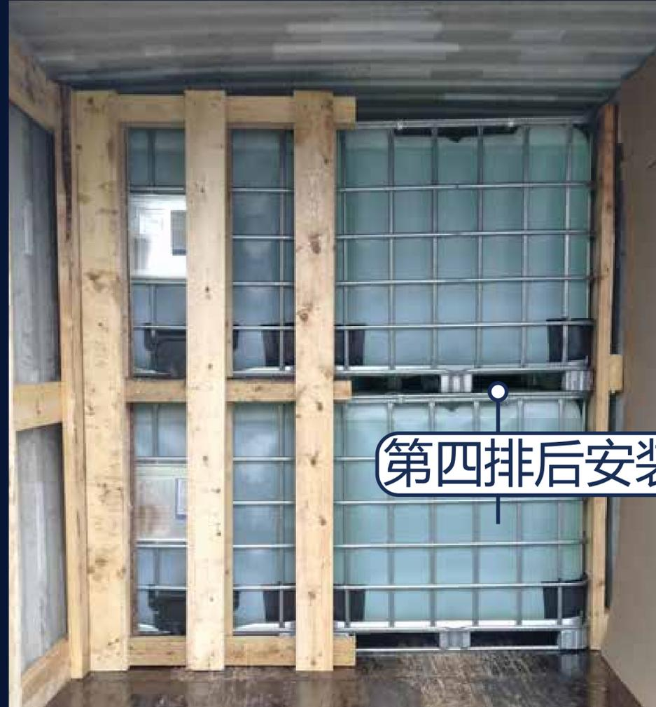
第四排后安装止推挡板
