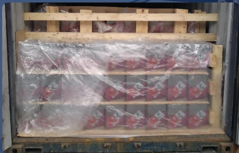
塞进并固定在门道的塑料膜照片
