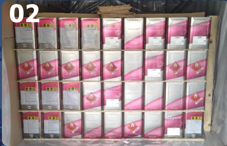
적재가 완전한 각각 행의 사진. 틈새가 있어서 측벽 실드가 설치되어 있는 건의 사진
