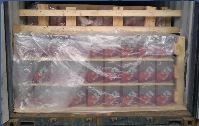
Фотография с заправленной и закрепленной в дверном проеме пленкой
