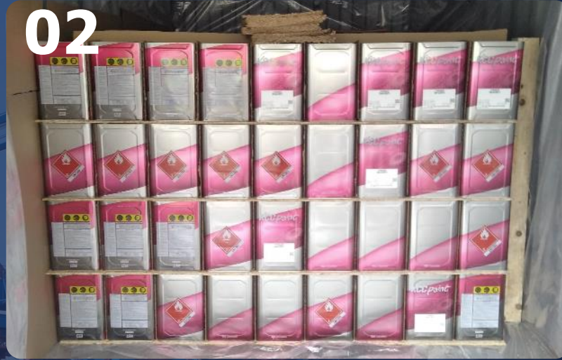
Фотография каждого полного ряда погрузки, если имеется зазор с установленной боковой рамой
